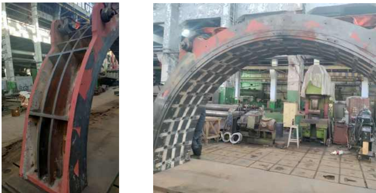
Рис. 2.14 – Зовнішній вигляд модернізованої станини з двома поясами кріплення та додатковими ребрами.
