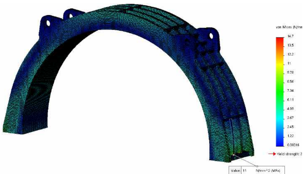
Рис. 3.17 – Епюра напружень в модернізованій станині при номінальних навантаженнях (напруження в контрольній ділянці 11 МПа, розмір максимального елемента 20 мм)
