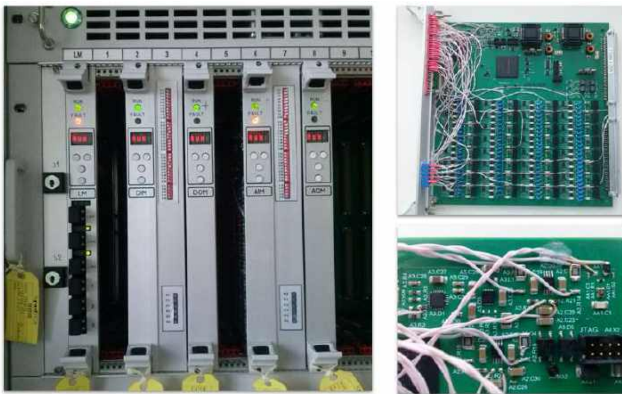
Рисунок 4.4 – Зразки модулів сертифікованої платформи RadICS та елементів стенда для її верифікації шляхом інєктування дефектів
