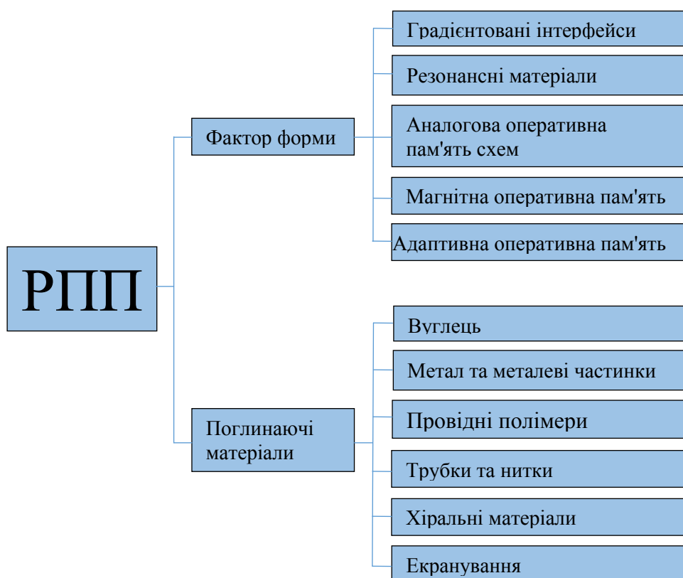
Рисунок 1.11 – Класифікація поверхонь поглинання сигналу РСА [28, 29].
