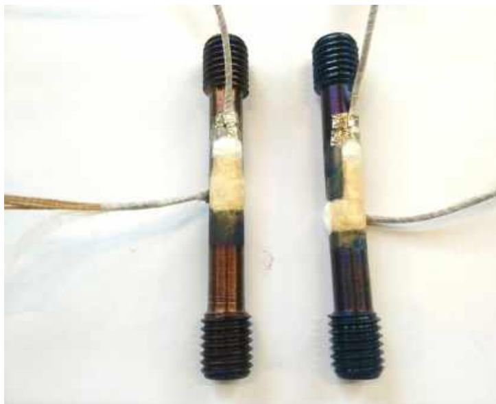
Рис. 2.10 - Препарований тензOMETром стандартний зразок для випробувань на розтяг
