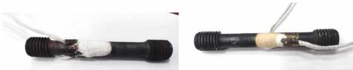
Рис. 3.2 - Препарований тензометром циліндричний, стандартний зразок діаметром 10 мм для випробувань на розтяг
