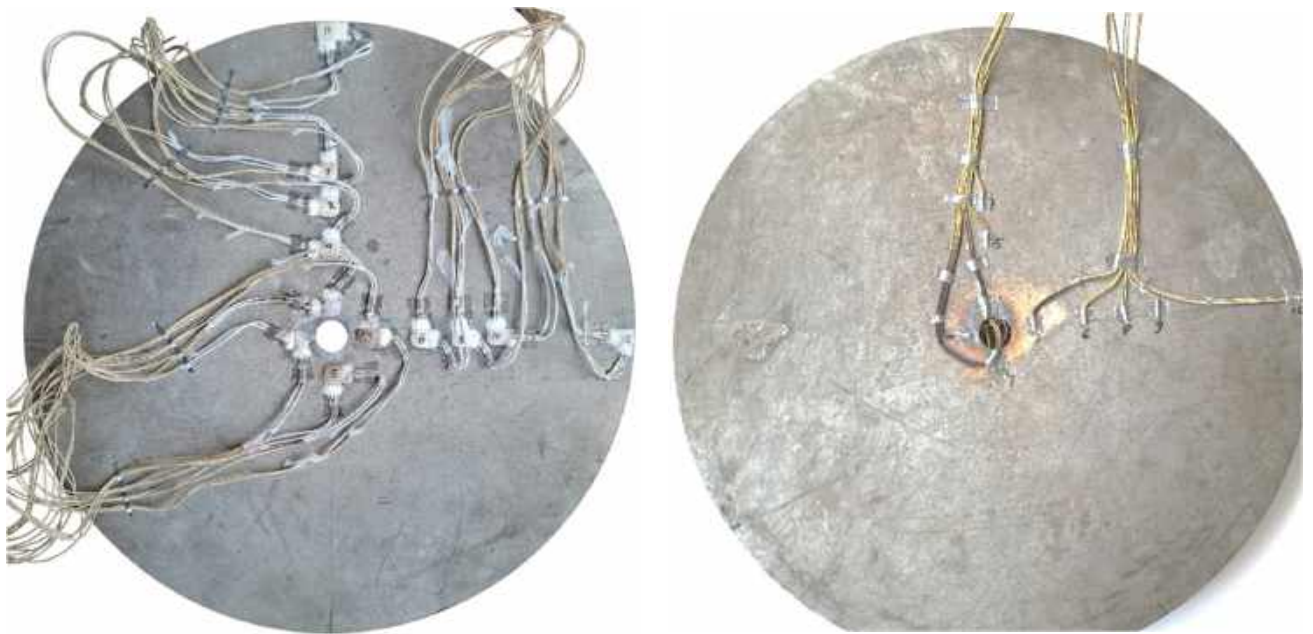
Рис. 5.2 – Диск із розміщеними тензомерами та термопарами
