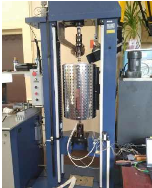
Рис. 3.3 – Випробувальна машина РМ–100 для досліджень на розтягстик із встановленою пічкою
