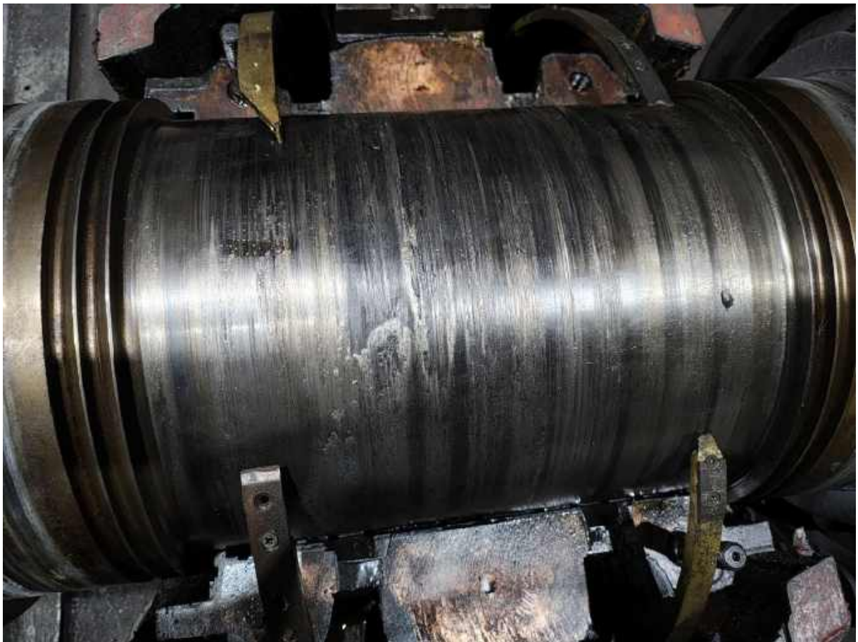
Рис. 4.1 – Пошкодження шийки валу
