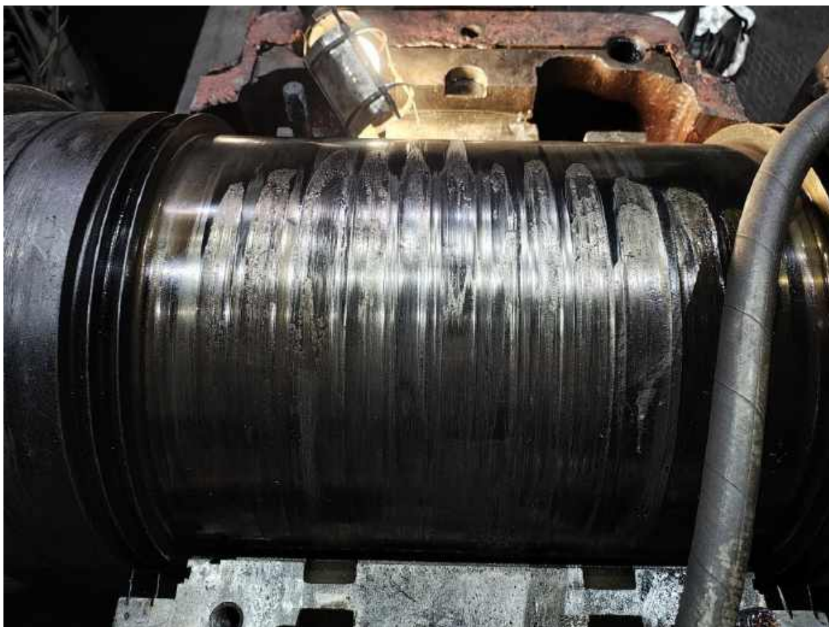
Рис. 4.2 – Пошкодження шийки валу
