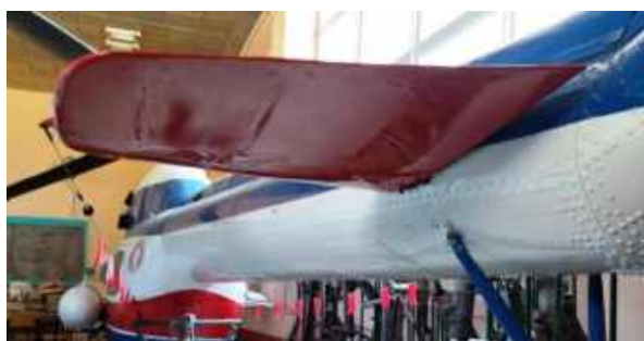
Рисунок 11 – Дослідна авіаційна деталь зовнішнього контуру (стабілізатор)
