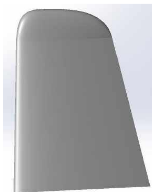
Рисунок 14 – АЕ стабілізатора за профілем НАСА 0012
