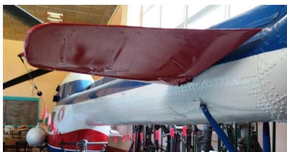
Рисунок 11 – Дослідна авіаційна деталь зовнішнього контуру (стабілізатор)
