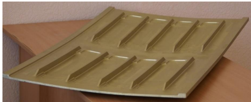
Рисунок 19 – Зразок інтегральної панелі подвійної кривизни, що формується та контролюється за РІ
