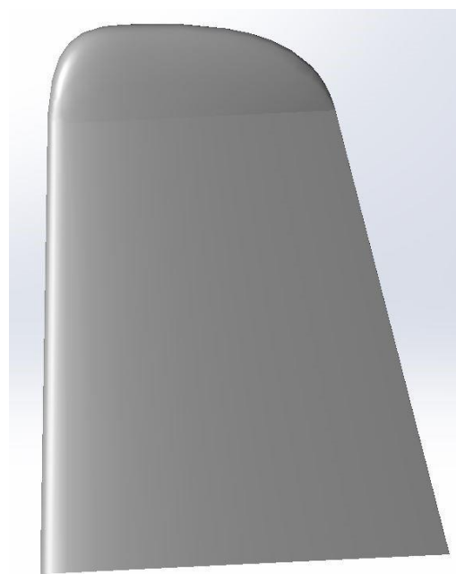
Рисунок 14 – АЕ стабілізатора за профілем NASA 0012
