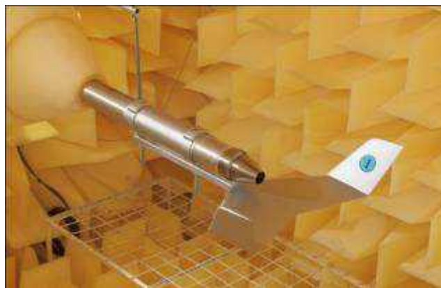
Рис. 25. Експериментальна установка для досліджень ефективності використання хвостового оперення літака як екрану-ючої поверхні для зниження шуму від реактивного струменя двигуна
