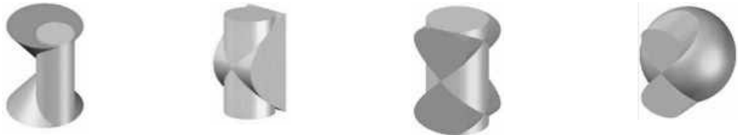
Рис. 1. Деякі випадки перетину поверхонь із утворюванням кривої Вівіані
