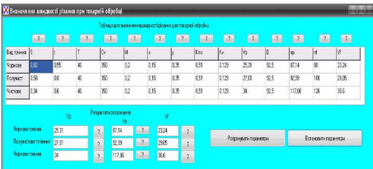
Рисунок 1. Екранна форма модуля для розрахунків швидкості різання токарної операції
