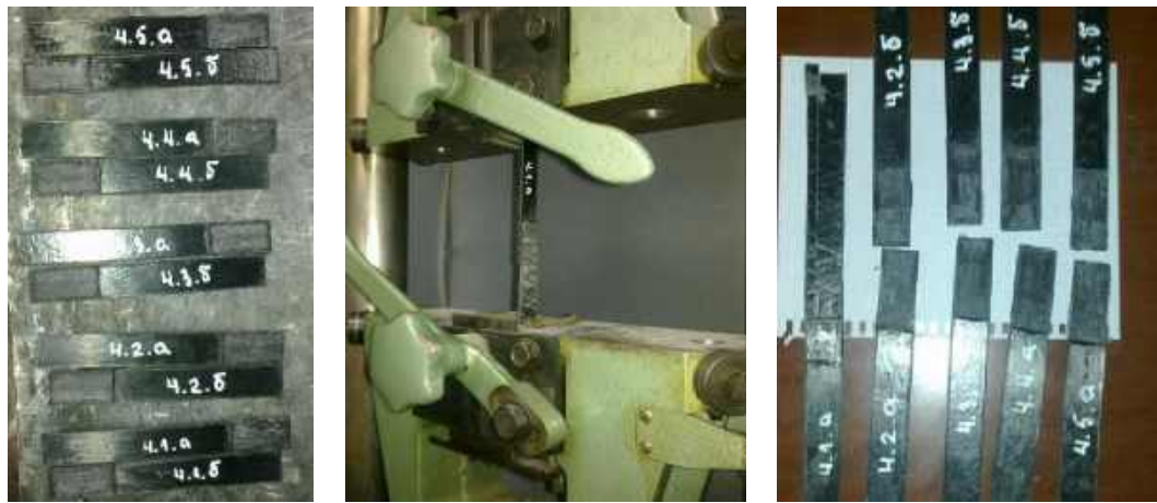
Рис. 2. Виготовленні й випробуванні зразки клейових з'єднань
