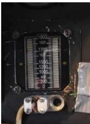
Рис. 5.4 – Індикатор потужності двигуна ІМД-2500
