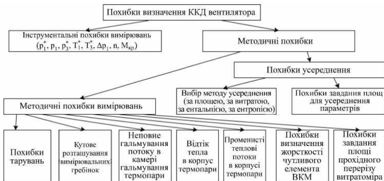
Рис. 3.1 – Похибки визначення ККД вентилятора
