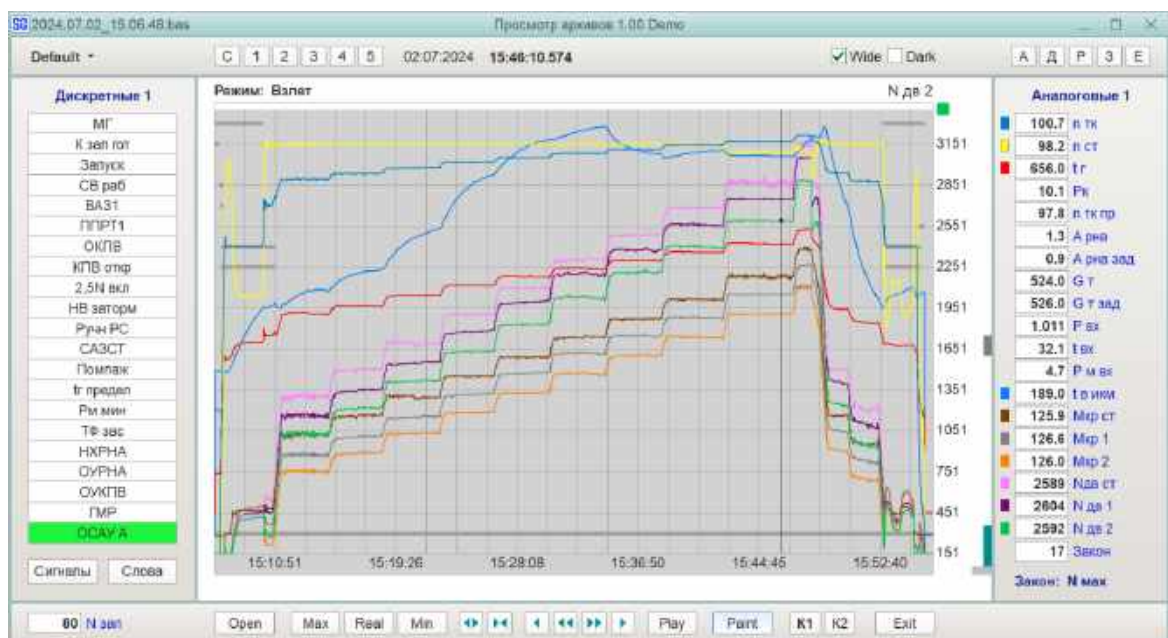
Рис. 5.9 – Приклад реєстрації параметрів для режиму 1950 кВт
