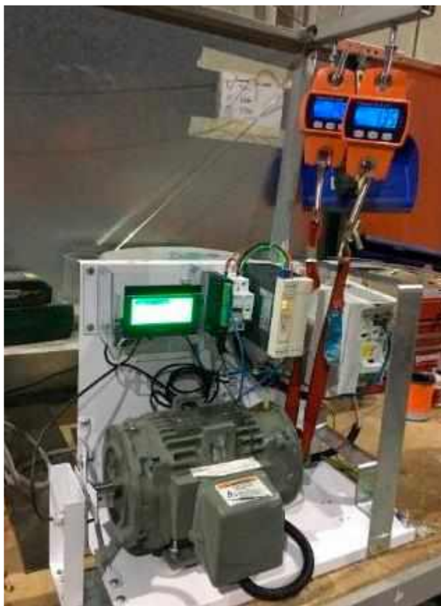
Рис. 1.3 – ВКМ на основі вимірювання натягу стрічки
