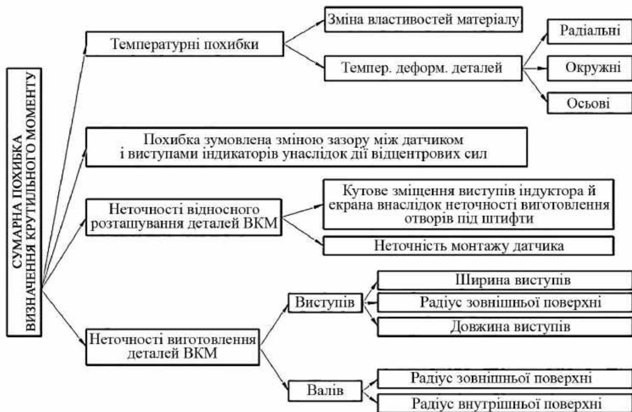
Рис. 2.5 – Структура похибки визначення крутного моменту
