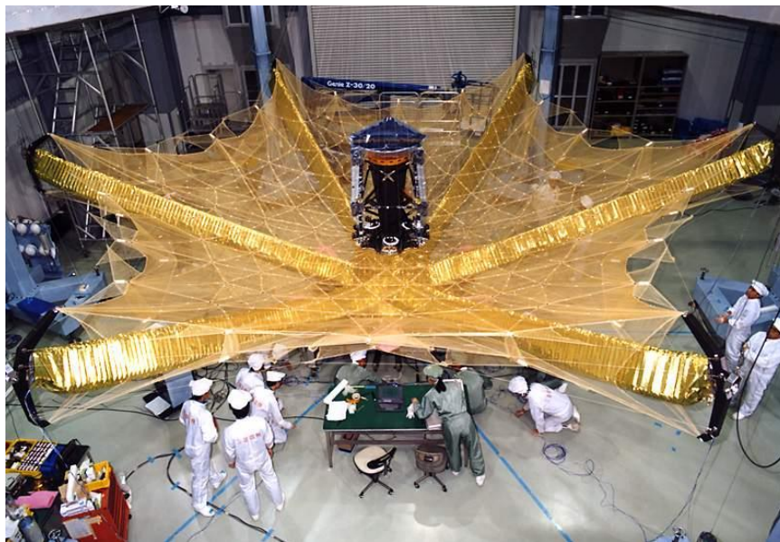
Рисунок 1.21 – Антена HALCA під час тесту розгортання. Взято з [101]
