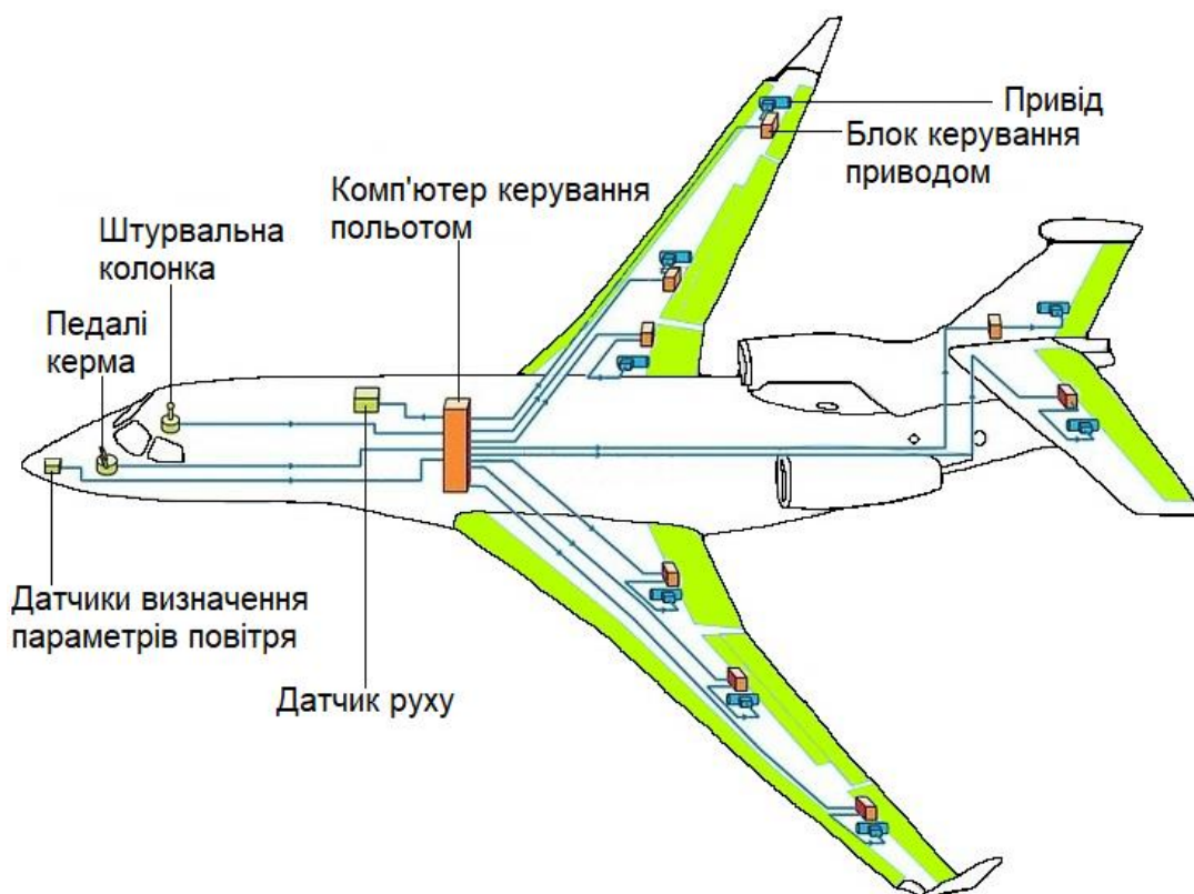
Рисунок 1.3 – Основні електричні системи управління польотом
