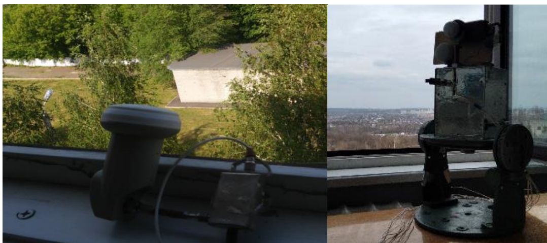
Рисунок 3.3 — Радіометр (а) 10.8--12ГГц ДХ ( \delta T=0.04 К) та блок радіометрів з рупорними антенами для статичних вимірювань T_{я} БПЛА (б).
