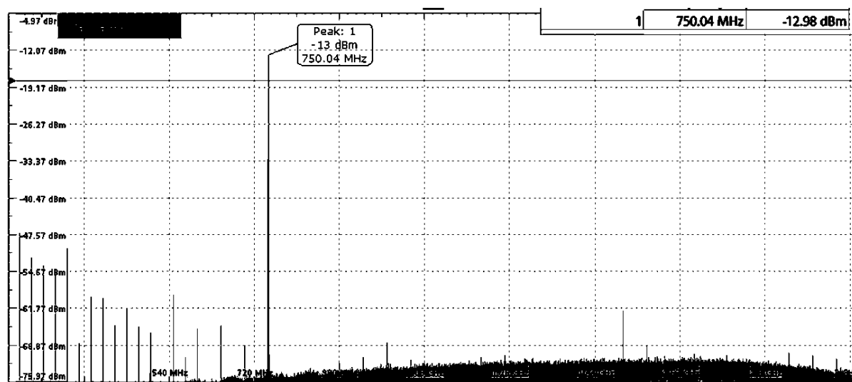
Рисунок 5.8 – Спектр сигналу на виході приймачів для випадку монохроматичного зондувального коливання з частотою 10,5 ГГц
