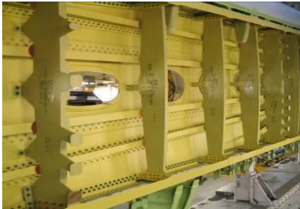
Рис. 16. Типові суцільнофрезеровані силові та рядові нервюри літаків фірми Боїнг
