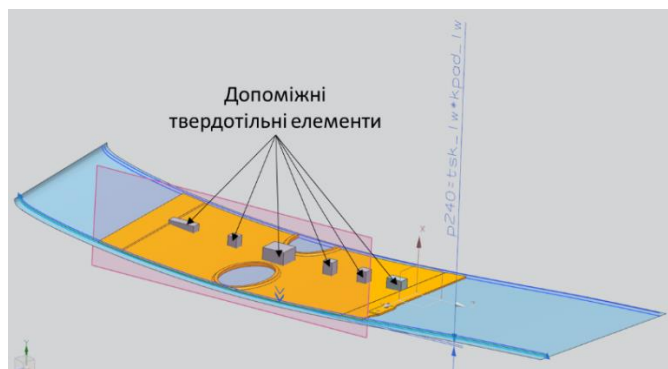
Рис. 46 Допоміжний ескіз для створення поверхні обрізання
