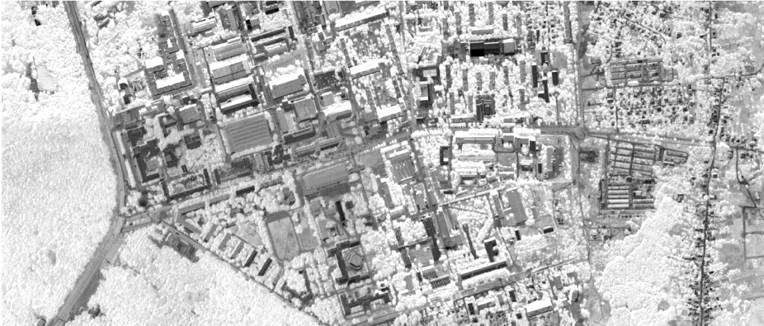
Рисунок 4.12 – Результат фільтрації радіозображення, отриманий за умови знання форми функції невизначеності радіосистеми
