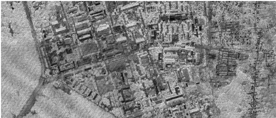
Рисунок 4.14 – Результат фільтрації радіозображення для функції невизначеності, зображеної на рис. 4.13.б
