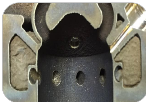
Рисунок 1.20 – Залишки порошкового матеріалу в порожнинах деталі
