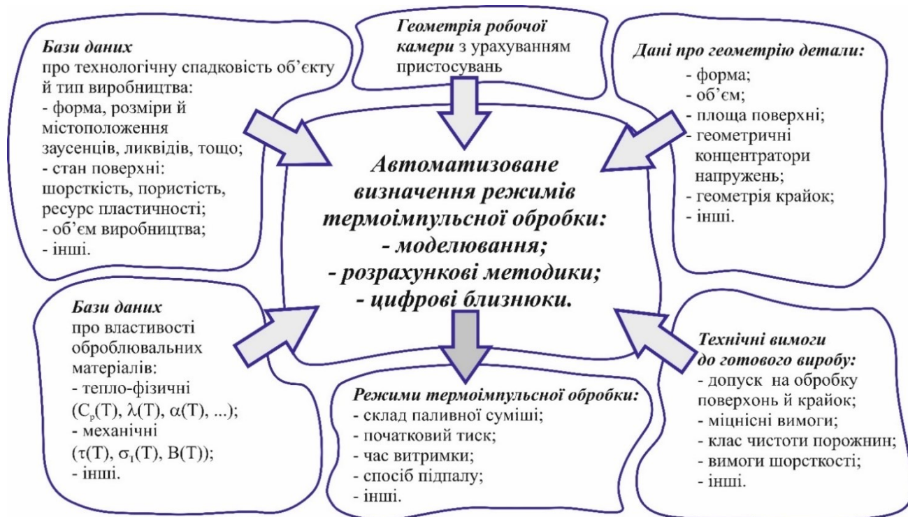
Рисунок 1.38 – Схема вхідних й вихідних даних задачі визначення режимів термоімпульсного оброблення
