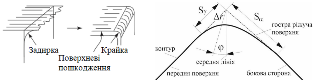
Рисунок 1.28 – Геометричні характеристики ріжучої крайки згідно [34]
