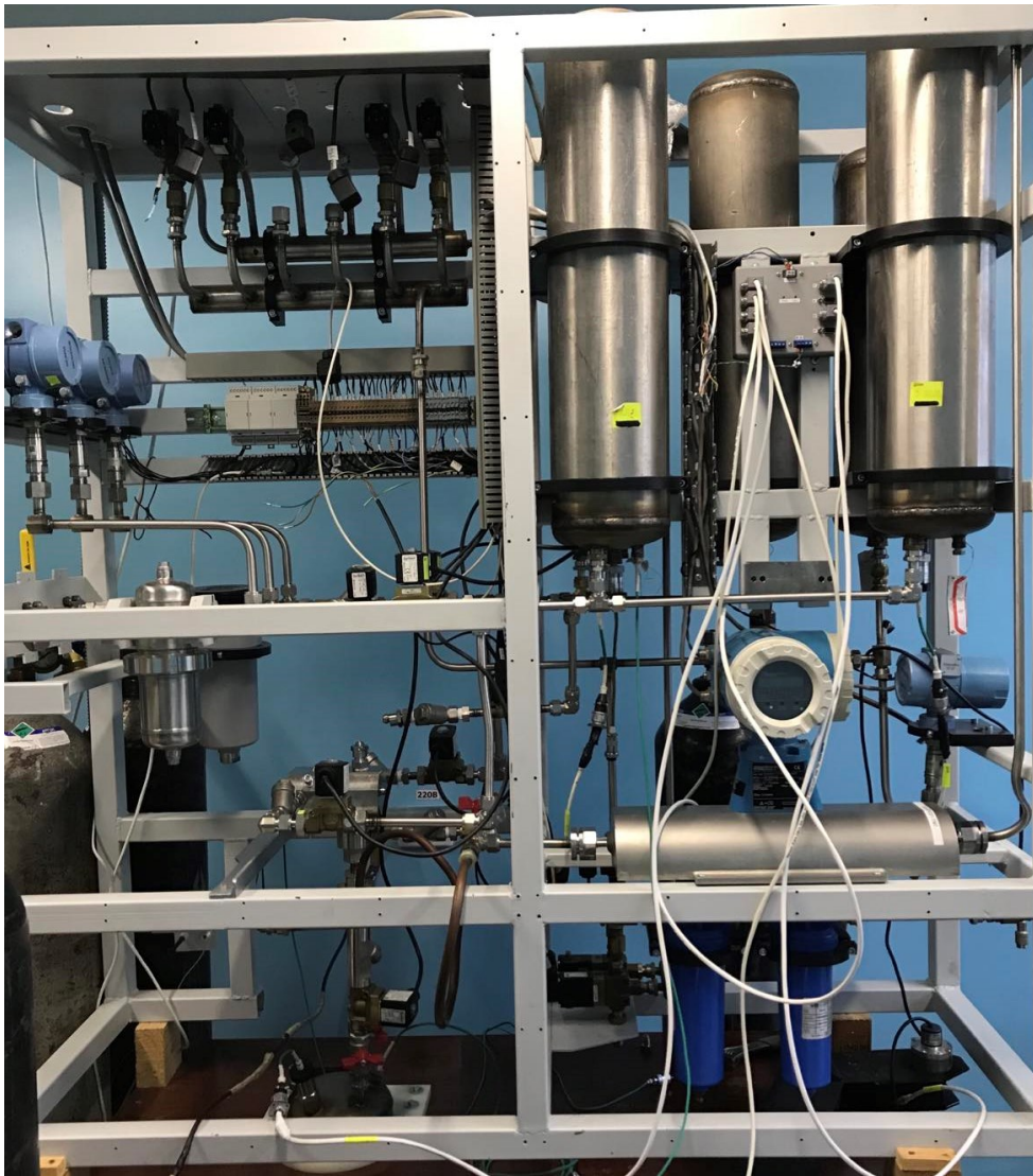
Рисунок 5.2 – Блок генерації паливної суміші
