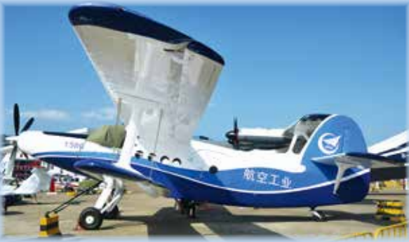
2018 р. КНР продемонструвала ремоторизований варіант китайської копії літака Ан-2 – Y-5BG, оснащеного американським турбогвинтовим двигуном і комплексом цифрової авіоніки
