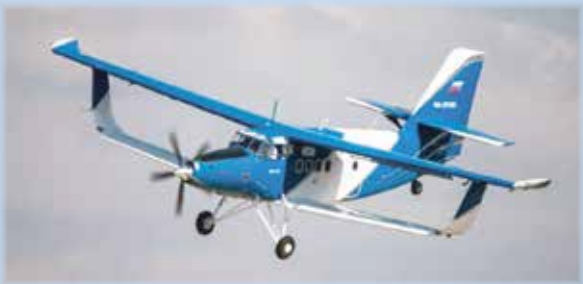
ТВС-2ДТ успадкував кращі конструктивні й аеродинамічні рішення Ан-2. Крило замкненого контуру, хвостове оперення, хвостову частину фюзеляжу і всю механізацію крила виконано з композитних матеріалів. Літак оснащено двигуном Honeywell, п'ятилопатеvim реверсивним гвинтом і комплектом сучасного пілотажно-навігаційного обладнання
