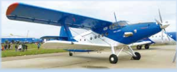
На ТВС-2МС (Росія) установлено американський турбогвинтовий двигун Honeywell з малошумним гвинтом і композитними крилами й стабілізатором
