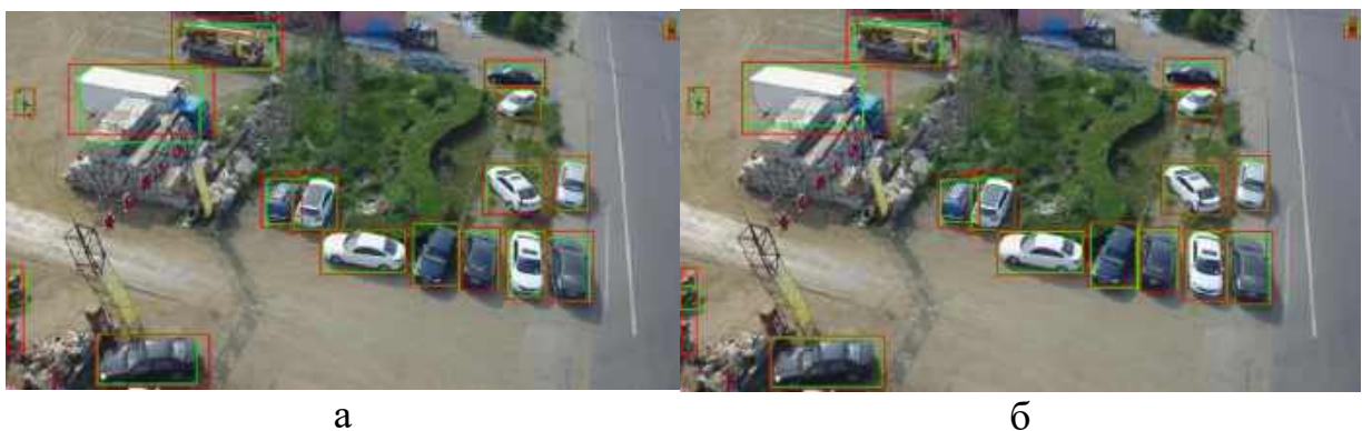
Рисунок 2.25 – Результат прогнозувань нейронної мережі SSD з VGG(a), MobileNetV2 (б)
