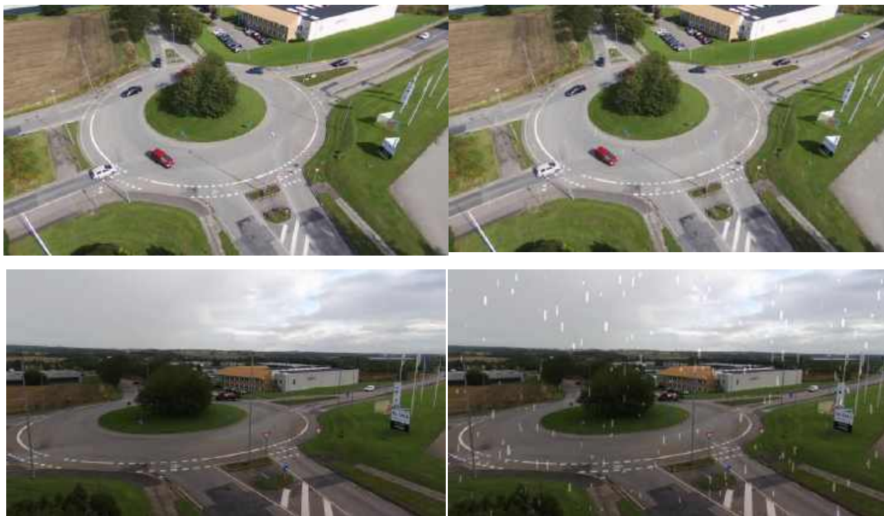
Рисунок 4.14 – Результат моделювання зображень, що піддані впливу дощу (праворуч) різної інтенсивності порівнюючи з оригіналом (ліворуч)
