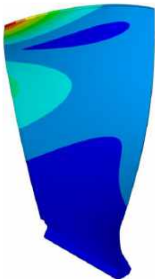
Рисунок 4.7. Результати четвертої частоти 390.78 Гц
