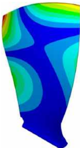
Рисунок 4.8. Результати п'ятої частоти 543.73 Гц
