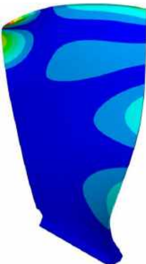
Рисунок 4.12. Результати дев'ятої частоти 978.89 Гц
