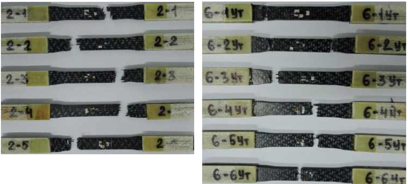
Рисунок 5.2. Зразки на розтяг після випробування
