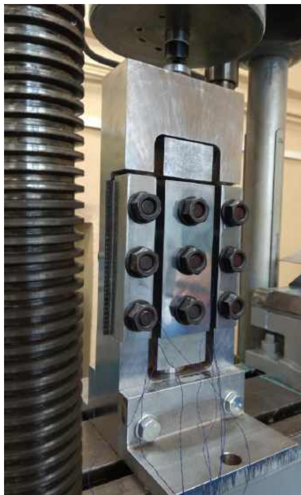
Рисунок 5.3. Спеціальний пристрій для закріплення та навантаження зразка на випробувальній машині
