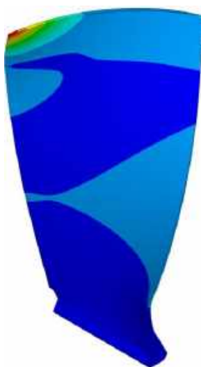
Рисунок 4.8. Результати п'ятої частоти 543.73 Гц
