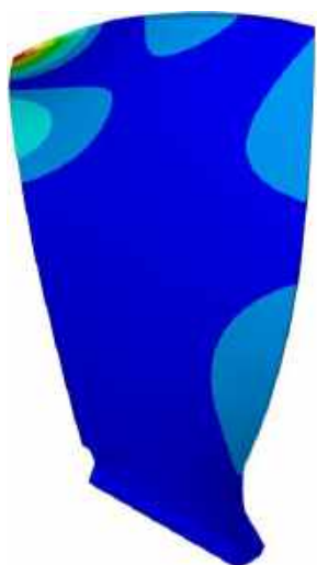
Рисунок 4.9. Результати шостої частоти 624.63 Гц
