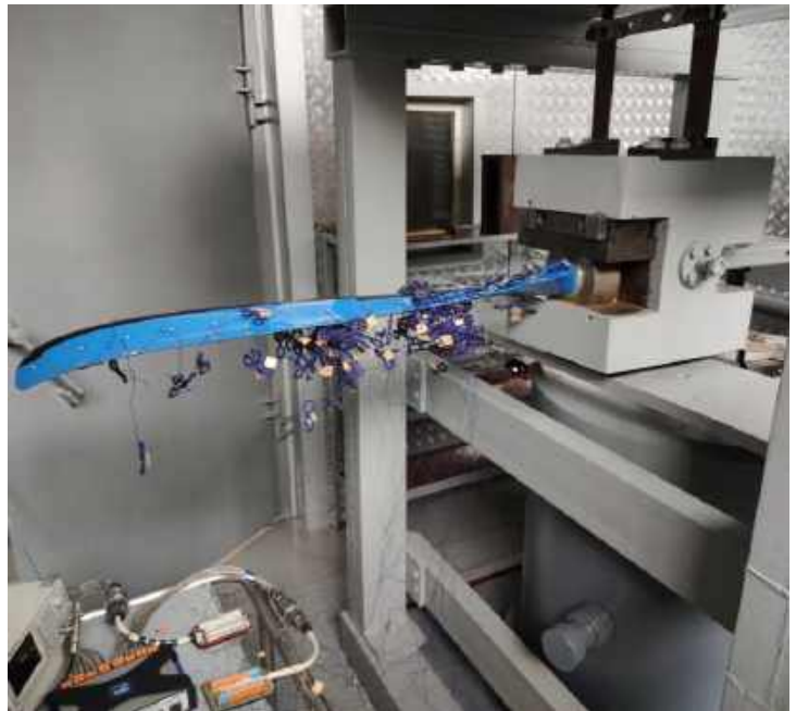
Рисунок 5.6. Препарована лопать на вібраційному електродинамічному стенді
