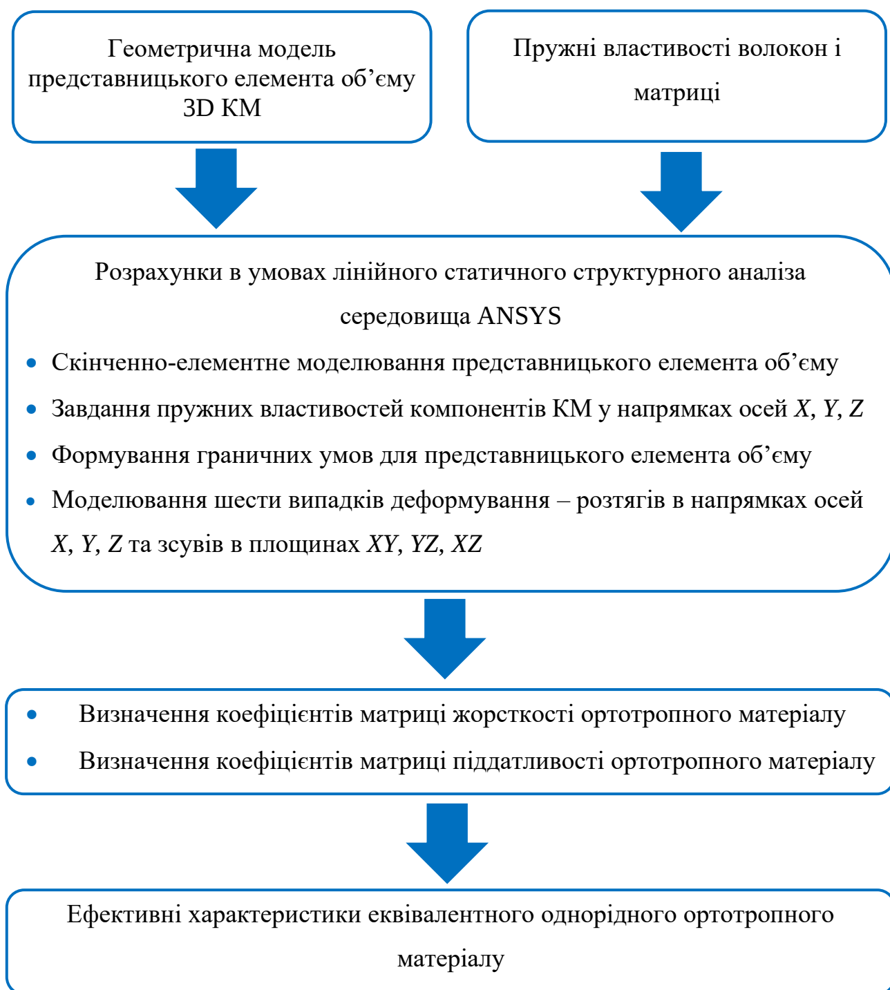
Рисунок 2.28. Схематичне зображення методу чисельного визначення ефективних пружних характеристик композиційних матеріалів
