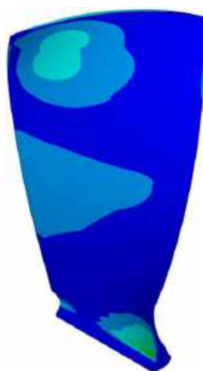
Рисунок 4.8. Результати п'ятої частоти 543.73 Гц
