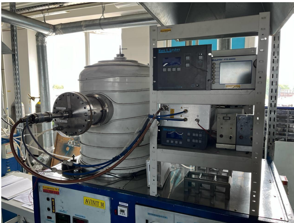
Рис. 2. Установа для нанесення покриття нікель-молібден
