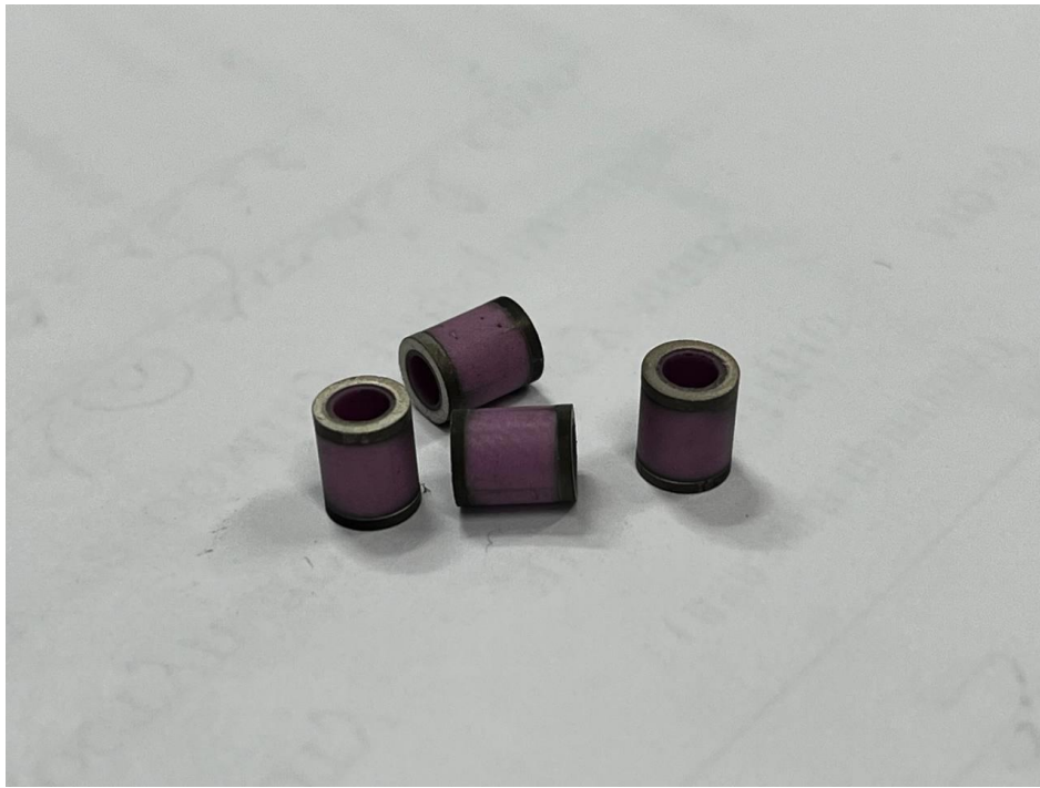
Рис. 1. Втулка керамічна з нікель-молібденовим покриттям
