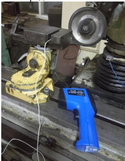
Рис. 1. Вимірювання температури пластини під час шліфування на верстаті 3Д642Е безконтактним способом
