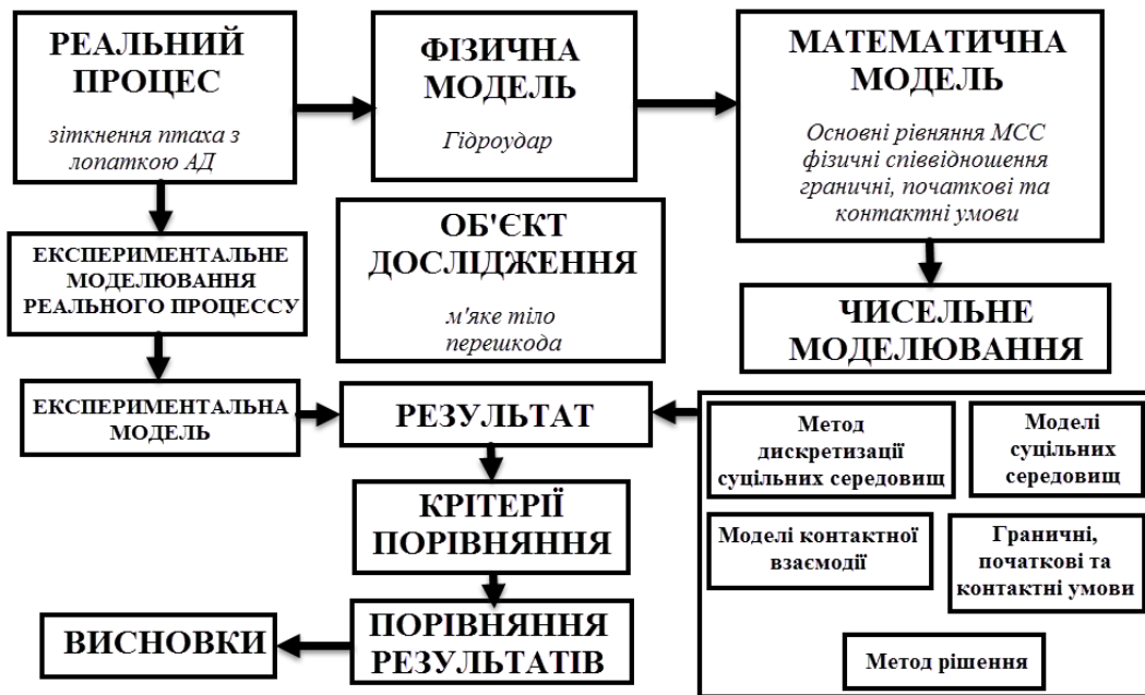
Рис. 2. Расчетно-экспериментальный метод исследования соударения птицы с лопаткой двигателя
