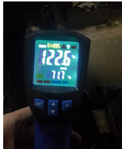
Рис. 1. Вимірювання температури пластини під час шліфування на верстаті 3Д642Е безконтактним способом
