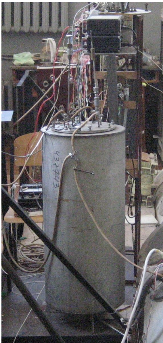
Рис. 3.19. Стендовий ресивер для визначення витрати РТ
