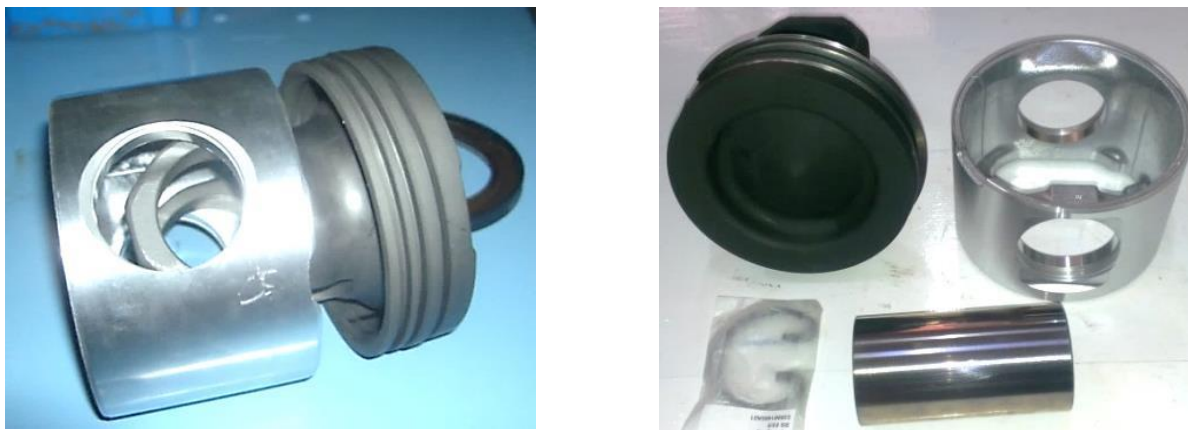
Рис. 4.2 Складений поршень форсованого автотракторного дизеля
