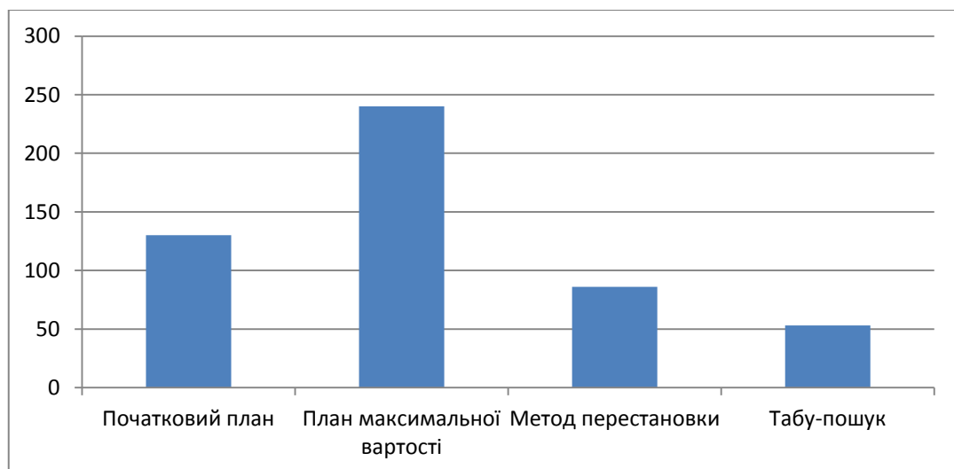
Рисунок 3.4 - Порівняння вартостей реалізації планів експериментів, отриманих різними методами оптимізації
