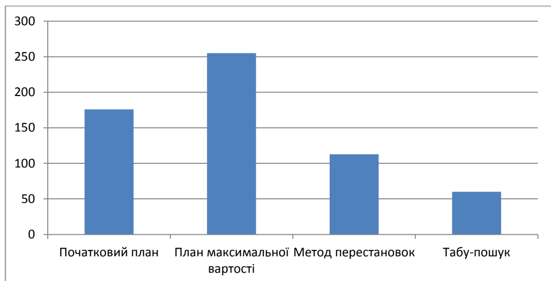
Рисунок 3.3 - Вартості реалізації планів експериментів при дослідженні вихорострумових вимірювачів товщини покриттів
