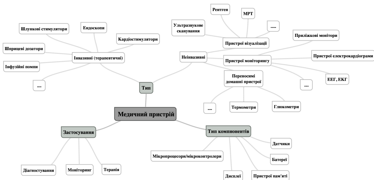
Рисунок 1.2 – Класифікація медичних пристроїв за критеріями типу пристроїв, мети застосування і типу компонент
