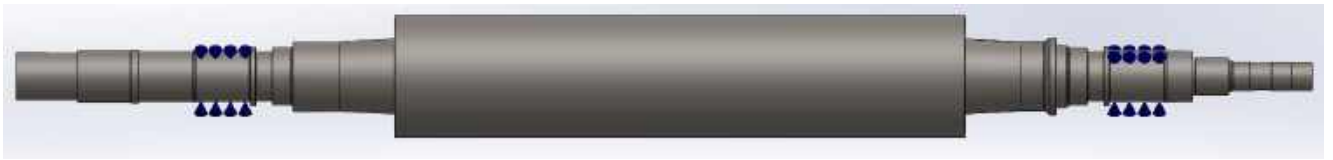
Рис.3.3 – Зусилля на підшипникових шийках вала
