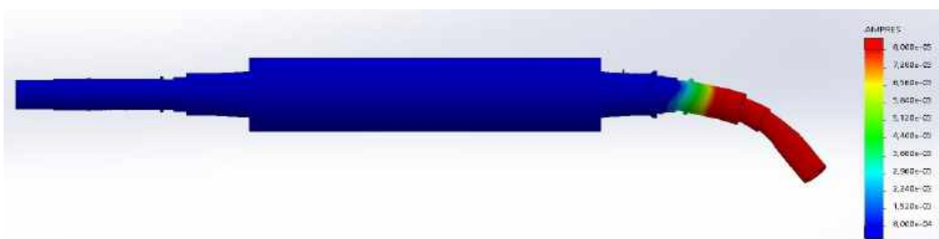
Рис. 3.8 – Третя критична частота (52,17 Гц)
