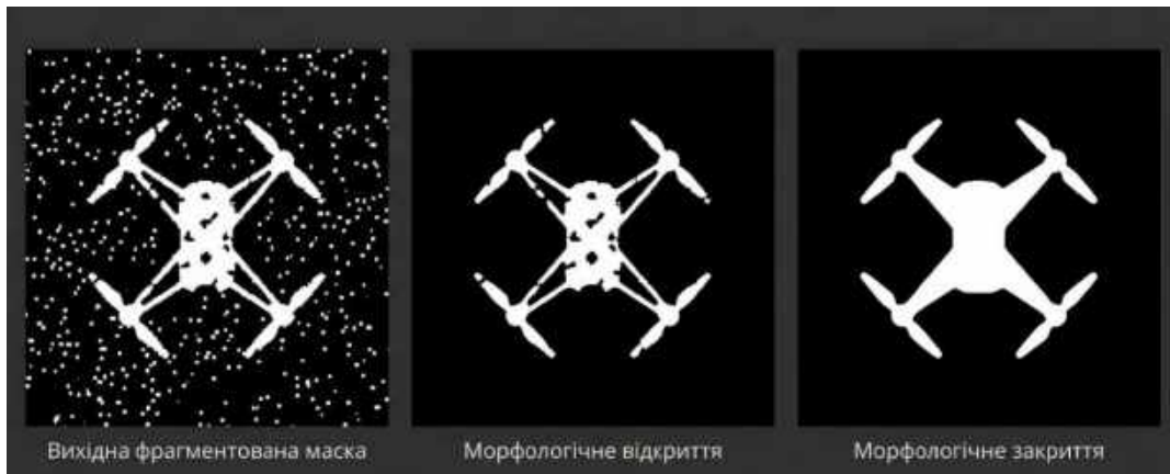
Рисунок 1.1 – Вплив комплексних морфологічних операцій на відновлення бінарної маски БПЛА
